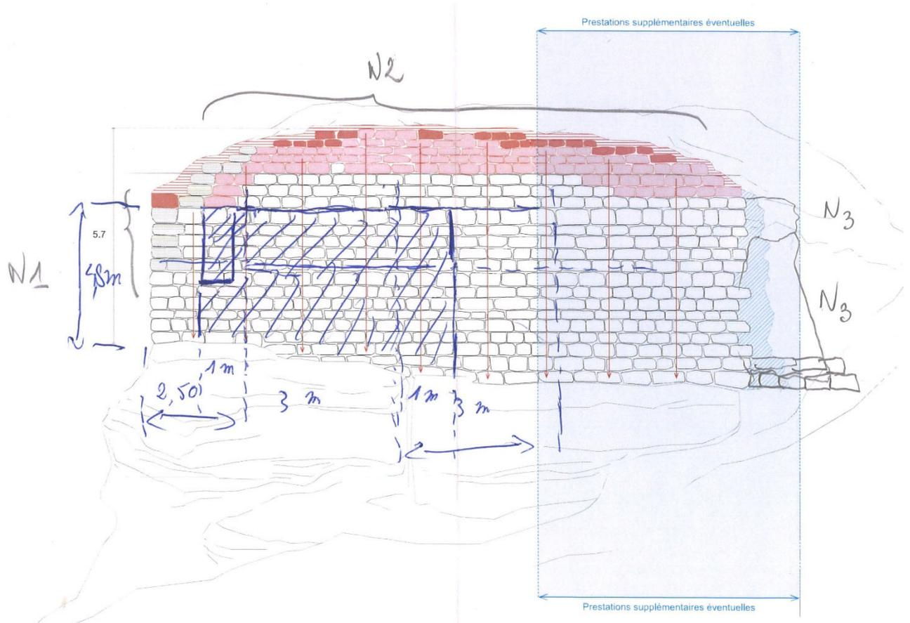
Rejointoiement en profondeur du parement conservé – Relevé du chef de chantier (en pointillé travées de l'échafaudage)
